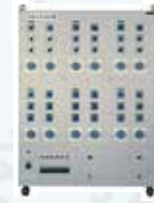
開閉器試験システム 電気スイッチ耐久試験用の電源装置+負荷装置で構成されたシステム (多くのスイッチメーカーに納入)
